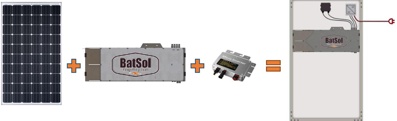
Le BatSol® est une **unité de stockage d'énergie** NiMH de 720Wh, un BMS intégré et une enveloppe mécanique associée.
