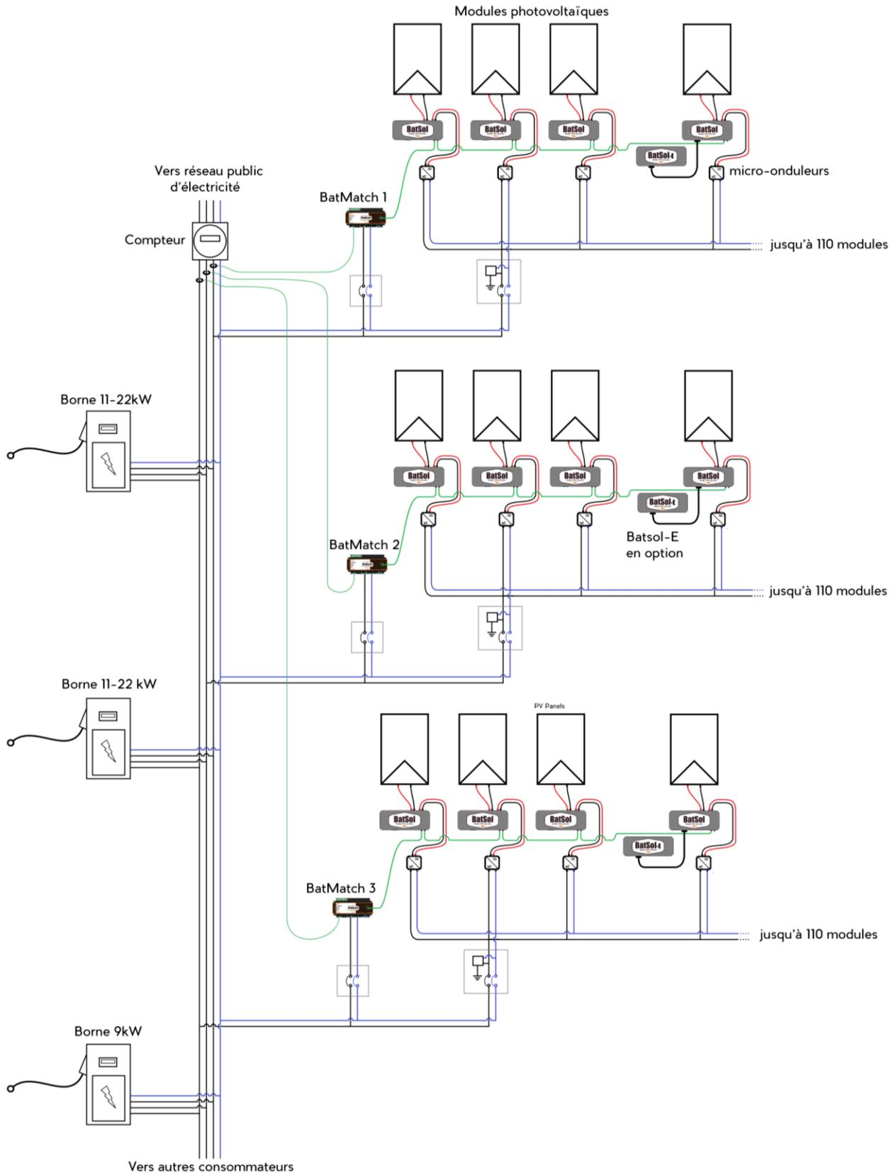
Utiliser un BatMatch par phase. Programmer les BatMatch en mode "Adjust". Support : [info@batsolpower.com](mailto:info@batsolpower.com)
